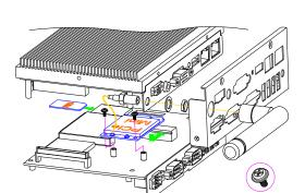
Step 3-2: Installing mini PCIe module and Antenna
