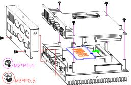
Step 3-1: Installing half-size mini PCle module if necessary.
